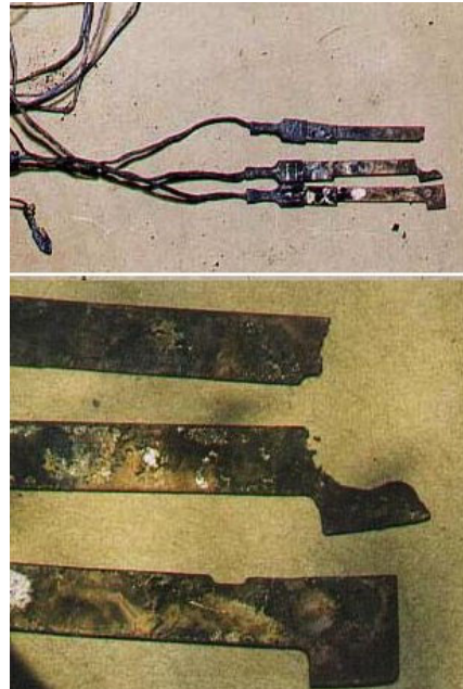
사진 3.7 냉장고 제상타이머의 접점에 형성된 불완전 접촉 발열흔
