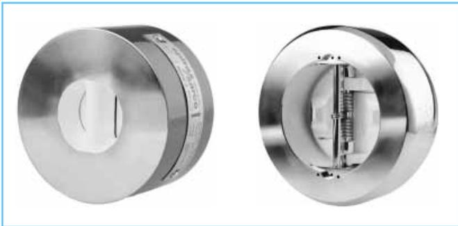
힌지(Hinge)를 중심부에 고정하기 위해 외부에 설치된 고정 핀(Retainer Pin)이 사용될 수 있다. 그러나 이런 고정 핀을 통해 밸브에서 누출이 생길 수 있다. 이를 보완한 향상된 설계 방법은 힌지(Hinge)를 내부에서 고정하는 것이고, 이 경우 몸체 내부에 밸브 메커니즘이 완전히 봉인되어 있기 때문에 외기로 유체의 누출이 될 수 없다.
